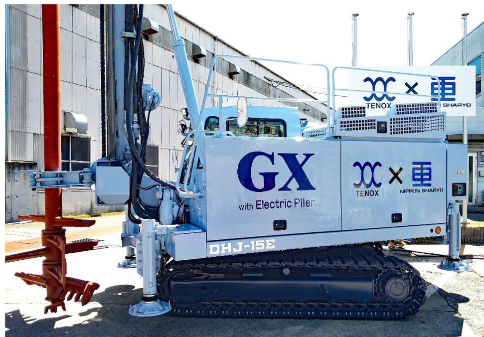
電動小型杭打機「DHJ-15E」試作機
