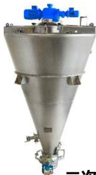
二次電池材料の原料を混合
