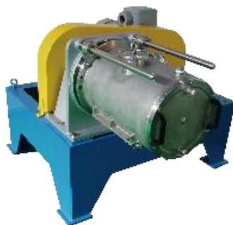
二次電池材料の粒子一粒ずつを被覆、精密混合して機能性を高める粒子設計
