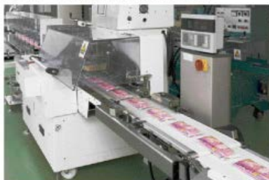
横ビロー包装機（製品の袋詰め工程）
