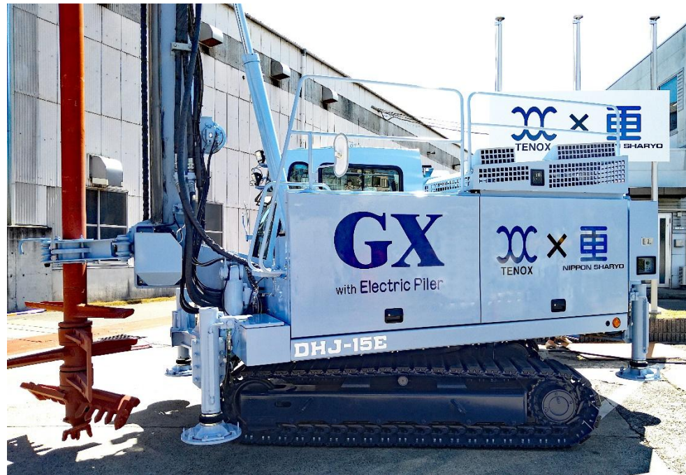
電動小型杭打機「DHJ-15E」試作機
